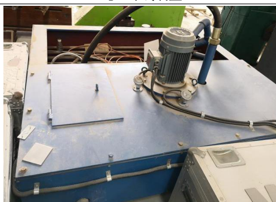
线模架（带油脂喷淋装置）
