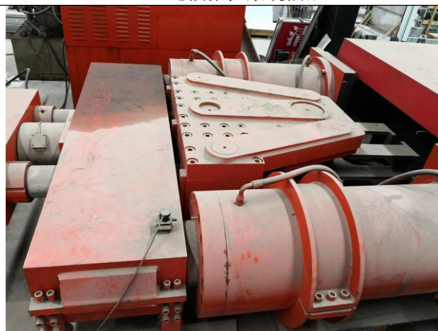
1000吨预张拉系统油缸
