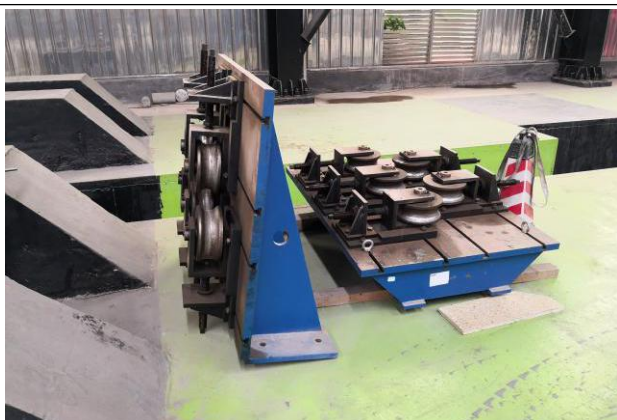
五轮式垂直水平较直装置
