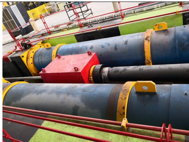
4200 吨预张拉系统油缸
