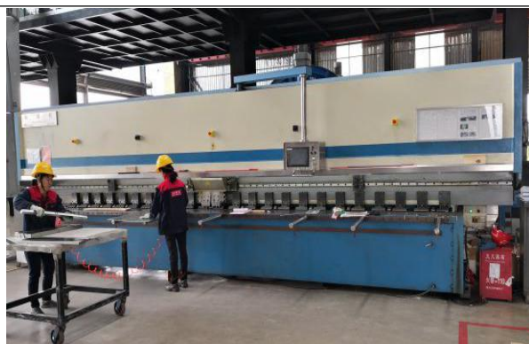
数控钣金 V 槽（双刀头）刨床
